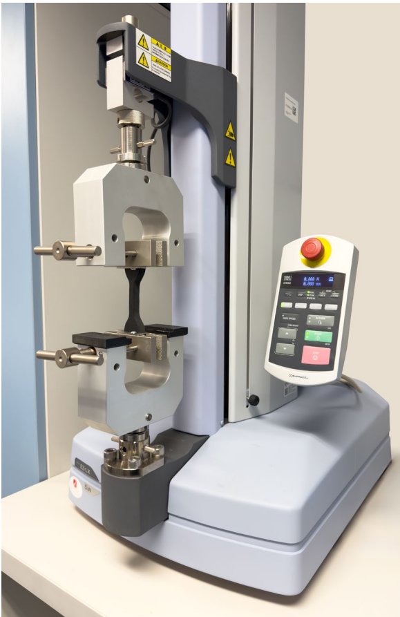
Fig. 6. Shim-pol EZ Test EZ-LX 5 kN testing machine
